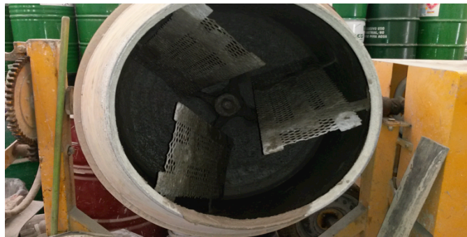
Imagen 10. Mezclador con aspas para generar burbujas de aire en el concreto celular
