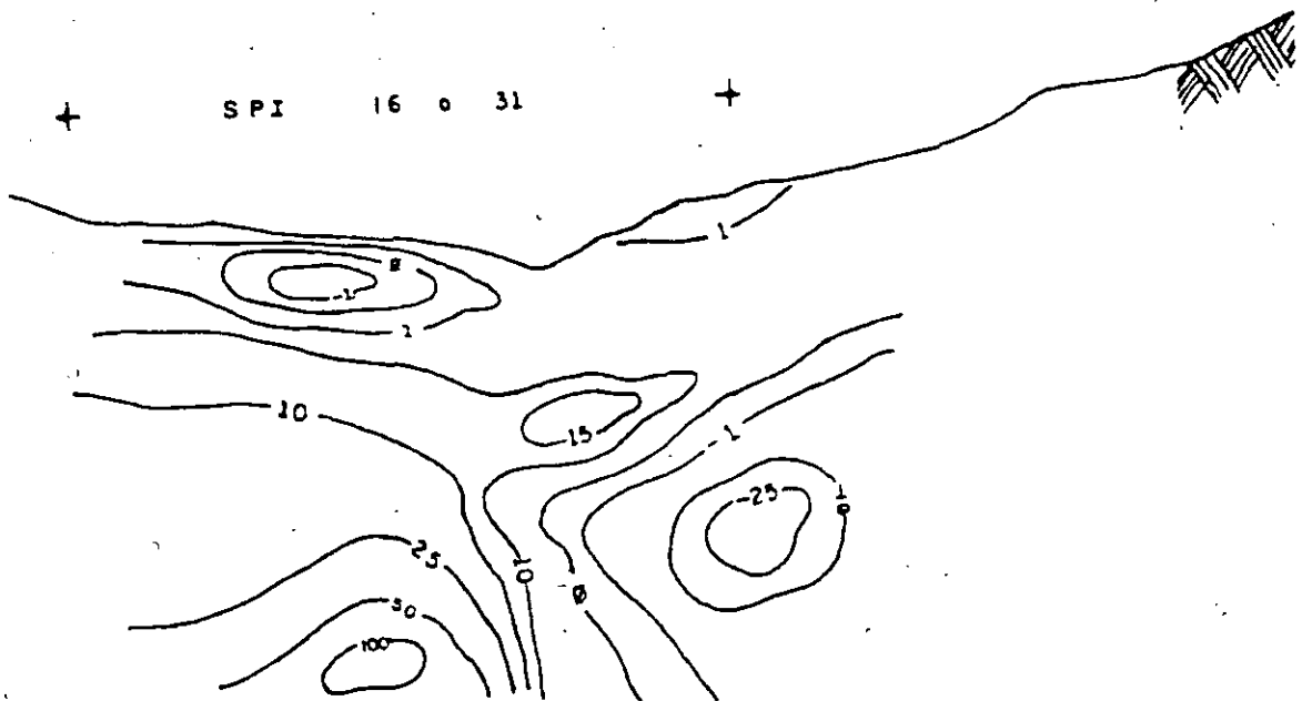
Figura 4.5 Polarización Inducida en el mapeo de zonas de alteración por infiltración de agua residual.
