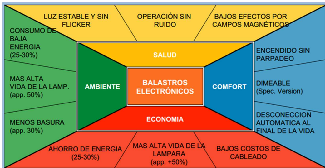
Figura 1-18 Comparación técnico-económica de un balastro electrónico
