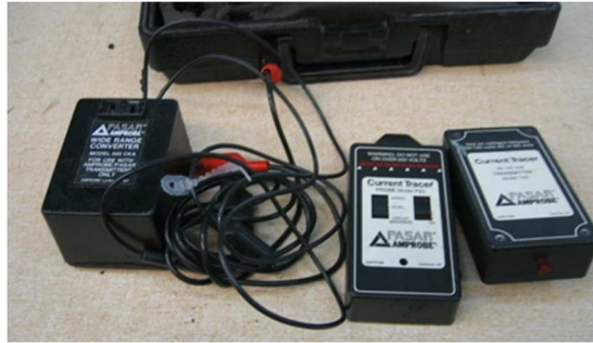
Figura 3-2 Trazador de corriente Amprobe P23
