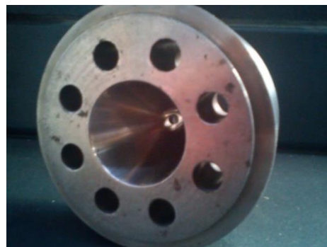
Figura 39. Dado circular utilizado para encontrar el perfil de procesamiento.
