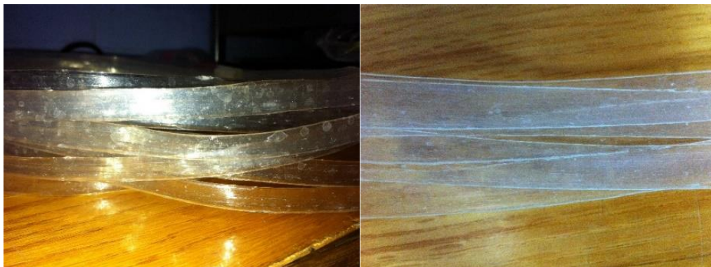
Figura 44. Primeros perfiles de PLA obtenidos con el dado de perfil rectangular.
