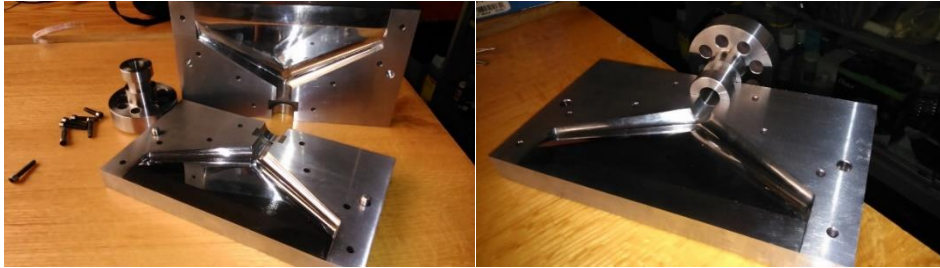
Figura 57. Dado de extrusión plano manufacturado.
