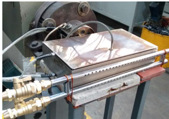
Figura 61. Tubos de enfriamiento por aire colocados en el dado.
