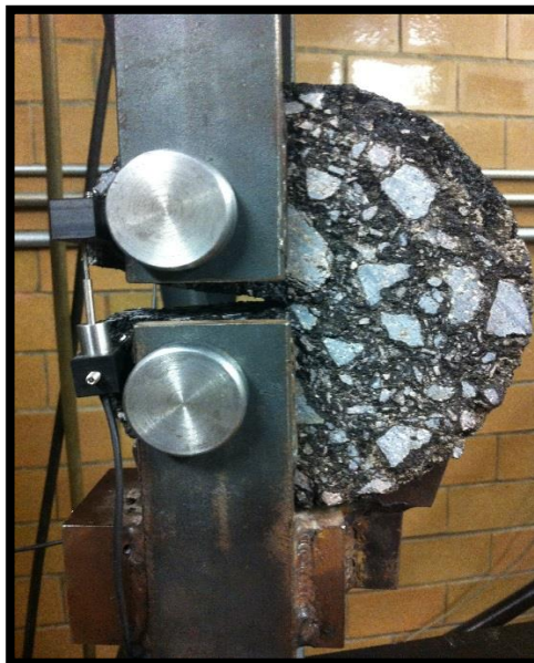
Figura 3.21 Probeta llevada a la falla a una velocidad de 0.017\text{ mm/s} .
