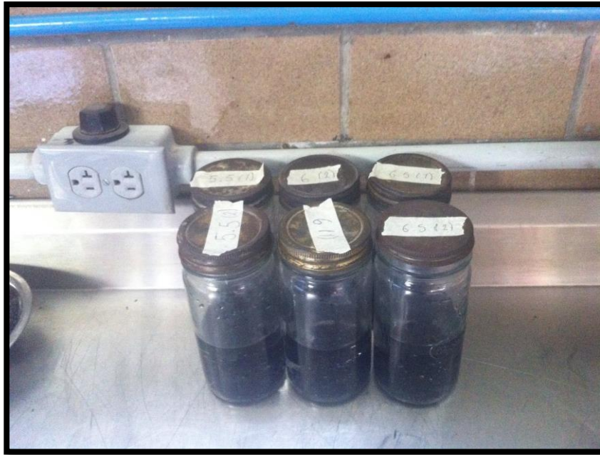
Figura A18. Muestras en reposo por 24 hr, con distintos contenido de asfalto
