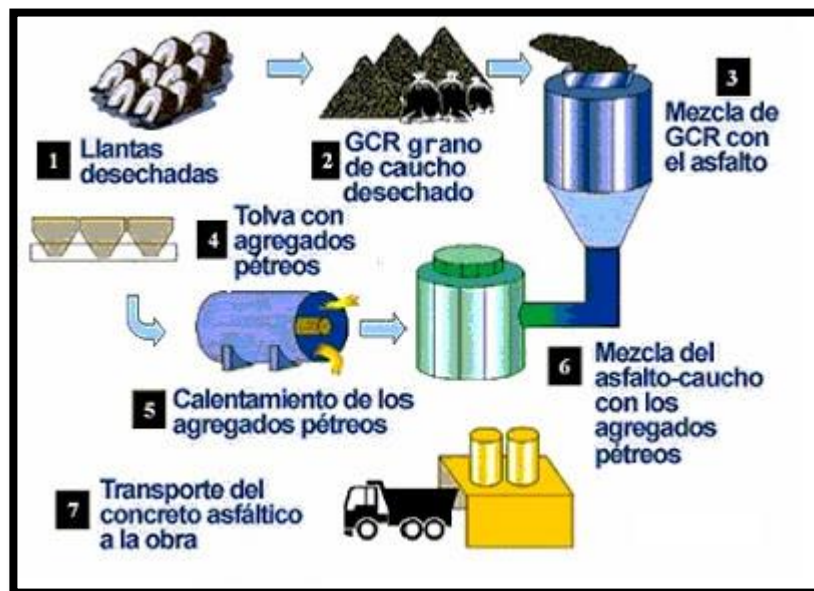
Figura 2.4 Proceso de adición de polvo NFU al asfalto por vía húmeda [35].
