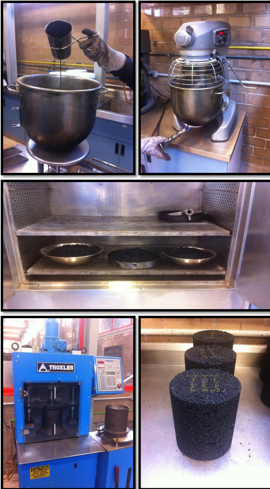
Figura A15. Procesos de mezclado y compactación de los especímenes realizados.
