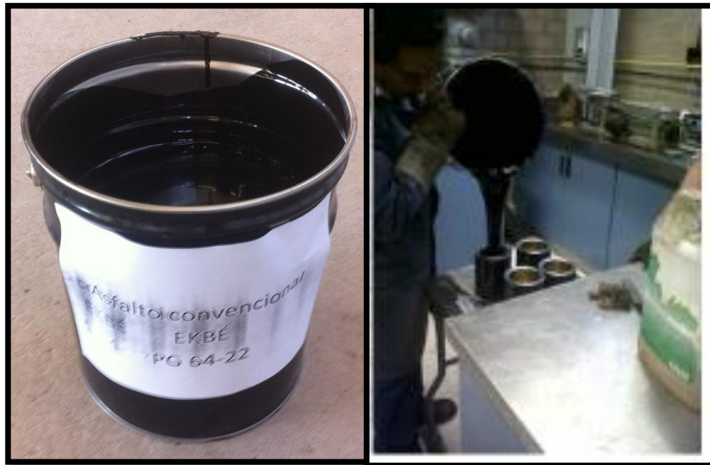
Figura 3.2. Asfalto EKBÉ PG-64-22.
