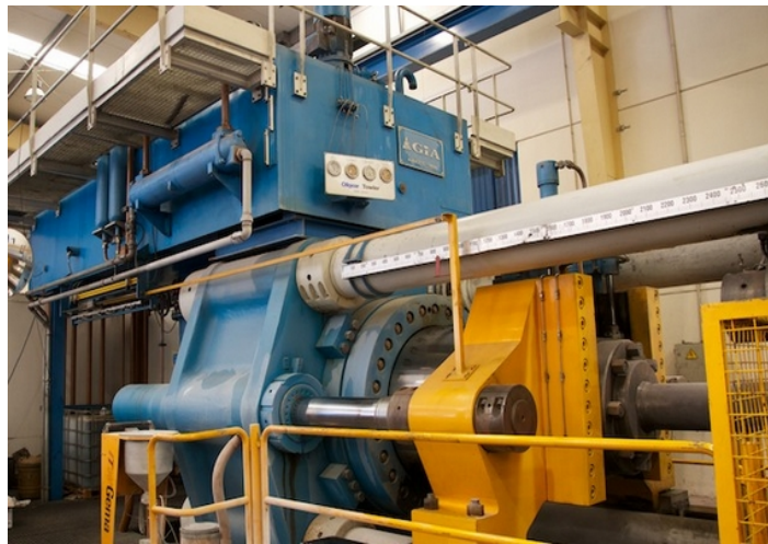
Figura 1.8 Prensa de 4 000 toneladas para extrusión de aluminio. [12]
