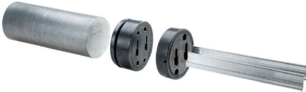
Figura 1.1 Proceso de extrusión donde el lingote se somete a un cambio de geometría. [2]
