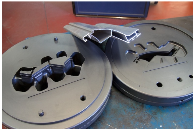
Figura 1.13 Dado mediante el cual se crea el perfil deseado con sección transversal constante [12]
