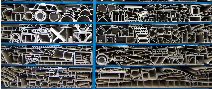
Figura 1.7 Mediante el proceso de extrusión se logran perfiles complejos. [12]
