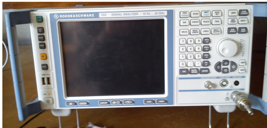
Figura 10. Analizador de espectro R&S FSV40.
