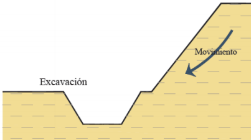
Figura 2.3.6 Excavación en el pie de un talud
