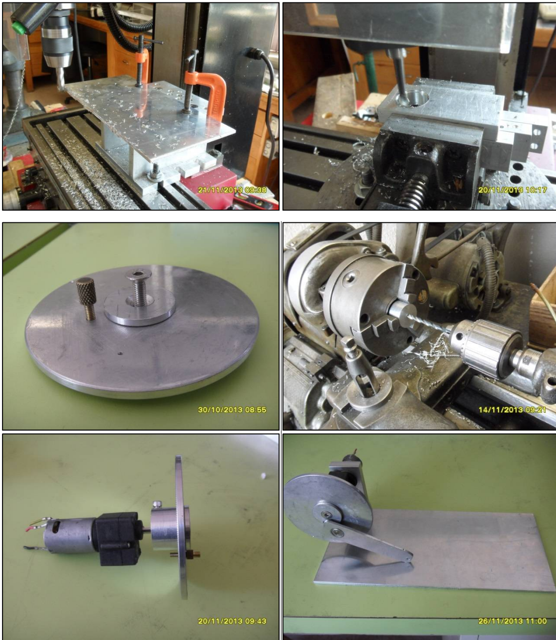
Figura 19. Diferentes etapas de la fabricación de un calibrador dinámico para probar las celdas de carga.
