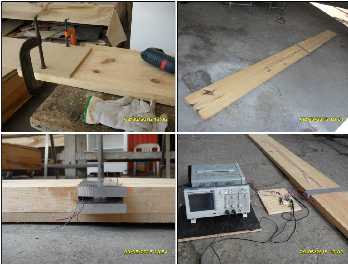
Figura 23. Montaje del arreglo de celdas de carga para prueba de campo.
