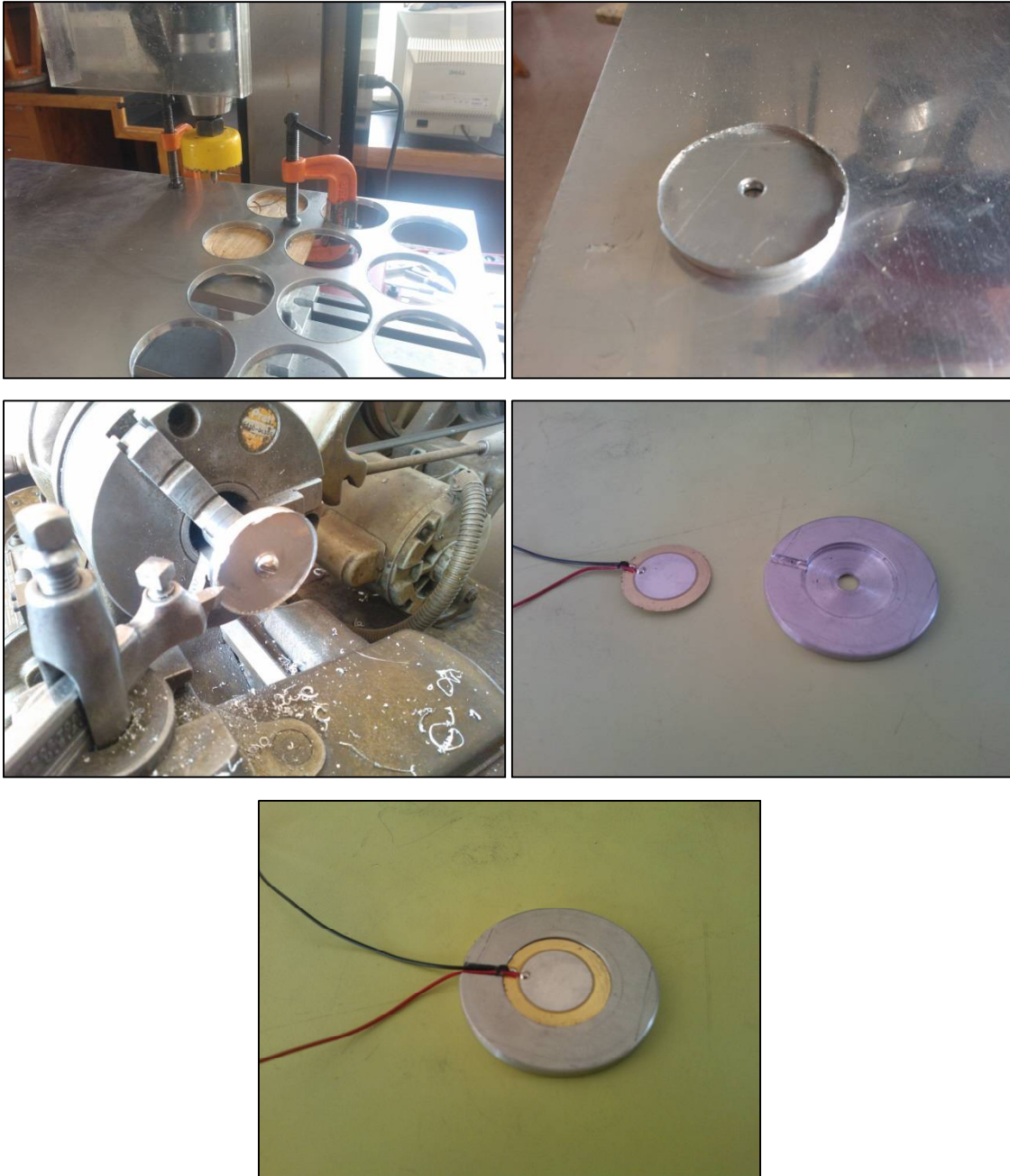
Figura 14. Diferentes etapas del proceso de fabricación de las tapas para los sensores.
