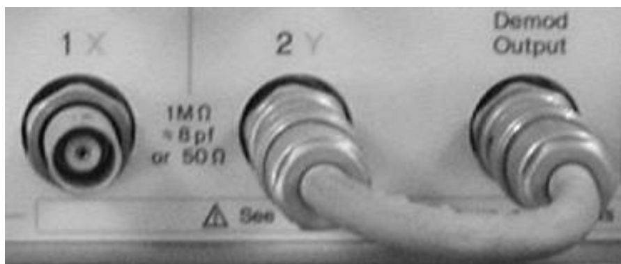
Figura 4.2 Parte del analizador de señales donde se muestran los bornes de entrada.
