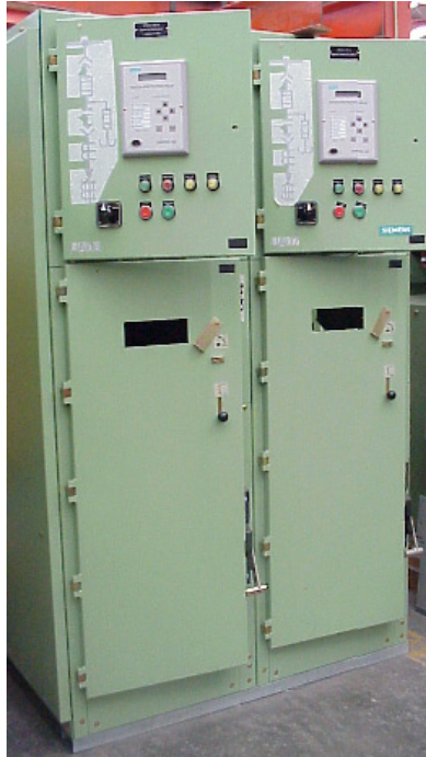
Figura 31. Tablero de MT ensamblado.
