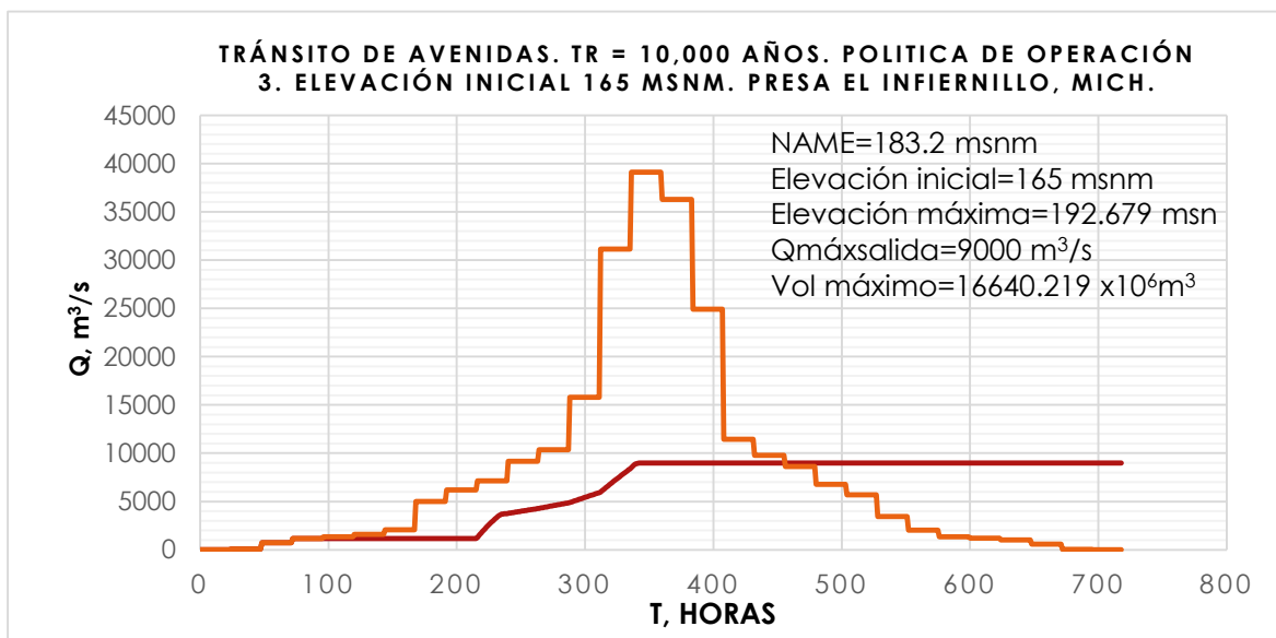
FIGURA 5.16. POLÍTICA DE OPERACIÓN CON LOS 3 VERTEDORES ABIERTOS
