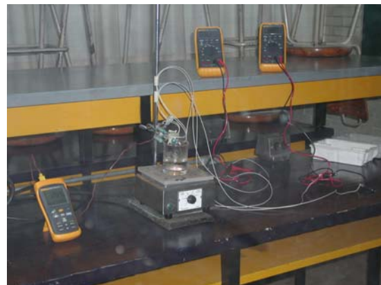
Figura 4.6.- Prueba realizada a los sensores de temperatura
