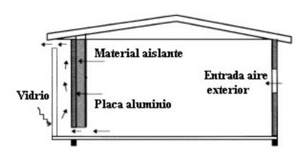
Figura 1.1 .- Sistema de descarga de calor
