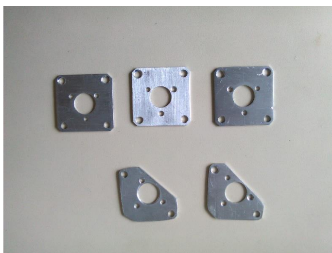
Figura 6.230 Soportes de aluminio para los motores EC-20.
