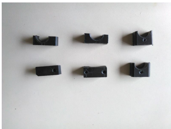
Figura 6.331 Sujetadores en Nylamid SL para bobinas de torque magnético.
