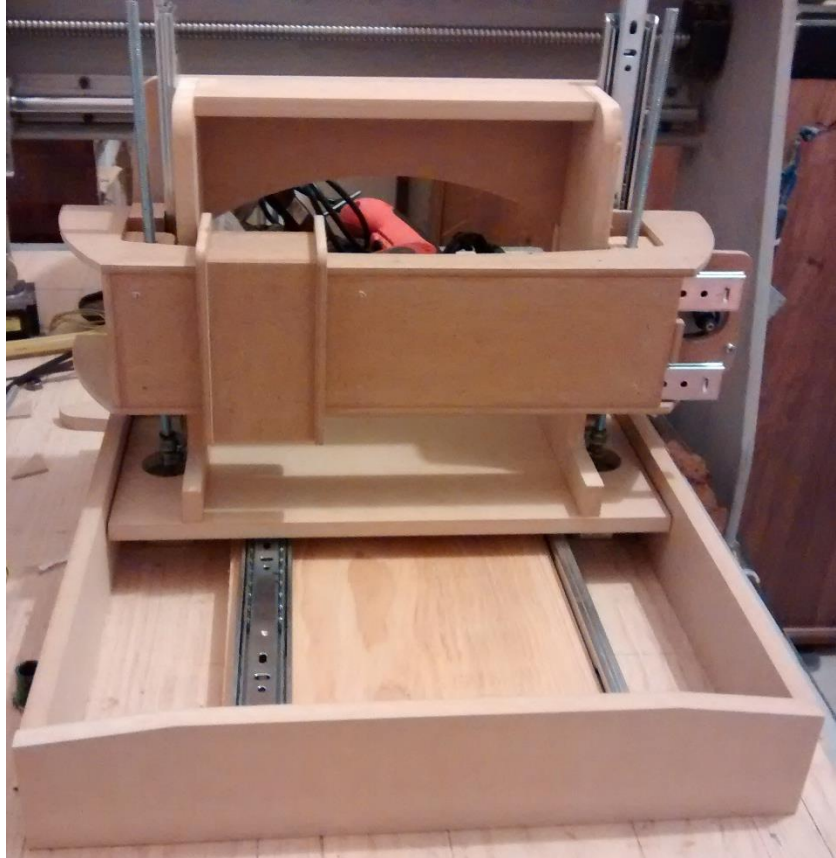
Ilustración 51. Ensamble del carro de Y y la estructura fija del prototipo de Bio-impresora 3D.
