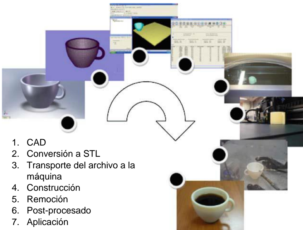
Ilustración 1. Proceso general de impresión 3D.
