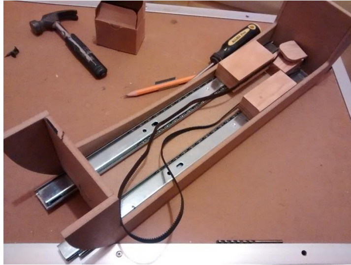
Ilustración 49. Montaje de guías lineales y banda dentada en el carro de Z de la bio-impresora.
