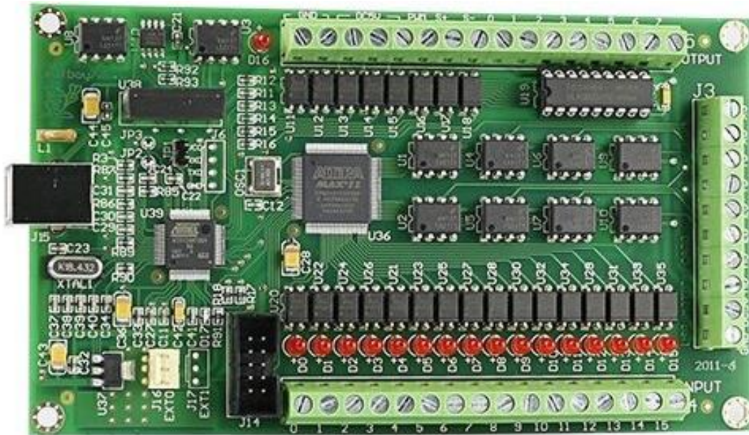
Ilustración 55. Tarjeta USB CNC leafboy 77 para conversión de información serial en señales de paso y dirección para el control de motores.
