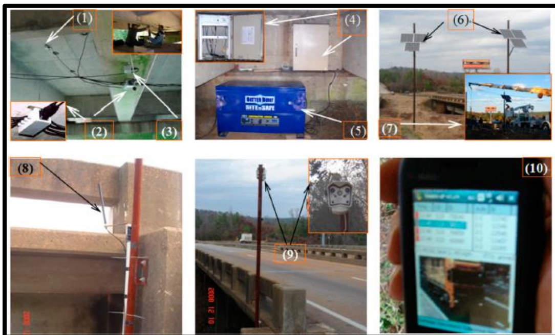
Figura 2.8 Componentes del sistema BWIM (Zhao y Uddin, 2014)
