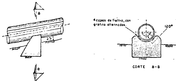
Fig. 21 Silleta para apoyo móvil
