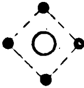
CUÑA "CINCO DE CRUZ" CON UN BARRENO DE GRAN DIAMETRO
