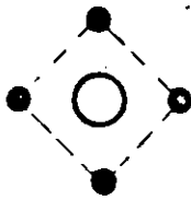
CUNIA "CINCO DE CRUZ" CON UN BARRENO DE GRAN DIAMETRO
