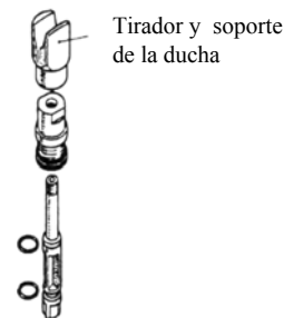
Figura 52. Despiece de un inversor manual.
