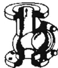
Figura 29. Válvula de retención de bola.
