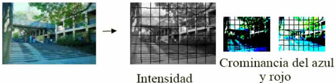
Figura 2.13 Proceso de eliminación de redundancia de la imagen
