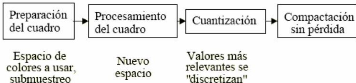
Figura 2.14 Proceso de compresión para cada imagen de video
