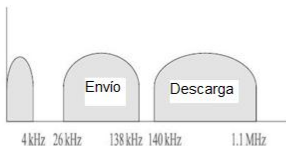
Figura 3.7 Utilización de frecuencias para ADSL
