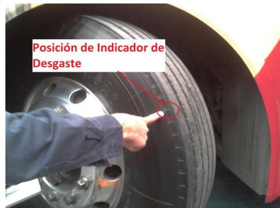
Figura 4.14. Fotografía marca lateral de indicadores de desgaste del neumático
