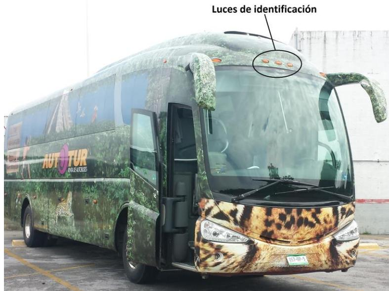
Figura 4.5. Fotografía Luces de Identificación de un autobús Scania PB.
