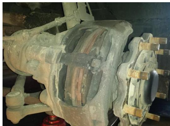
Figura 4.80. Fotografía de Sistema Frenos de Disco desmontados. A la izquierda rotor o disco desmontado, a la derecha vista del Caliper/Mordaza con balatas aun instaladas.
