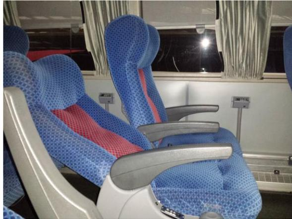
Figura 4.51. Fotografía de asientos para pasajeros con sistema de inclinación.
