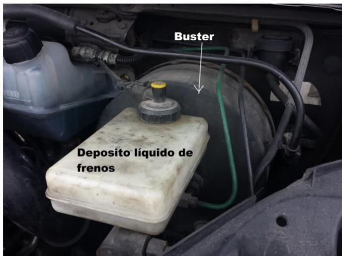
Figura 4.86. Fotografía Componentes Sistema de Frenos Hidráulicos ubicados en el compartimiento del motor.
