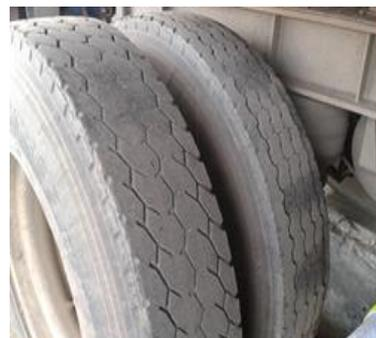
Figura 4.23. Fotografía Anomalía banda de rodamiento de un tracto-camión.
