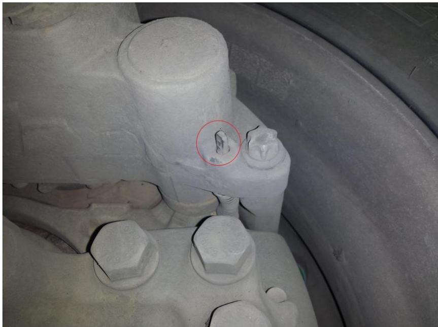
Figura 4.82. Fotografía de vástago para medición de desgaste en forro de frenos, valido para autobuses Volvo.
