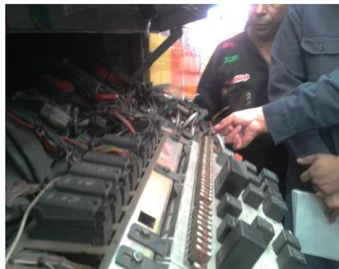
Figura 4.9. Fotografía de una central de fusibles exterior de un autobús Scania Visstabus.
