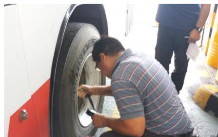
Figura 4.13. Fotografía de la toma de presión de inflado de un neumático.
