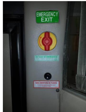
Figura 4.47. Fotografía del señalamiento de emergencia y mecanismo de apertura en caso de emergencia de la puerta de servicio.
