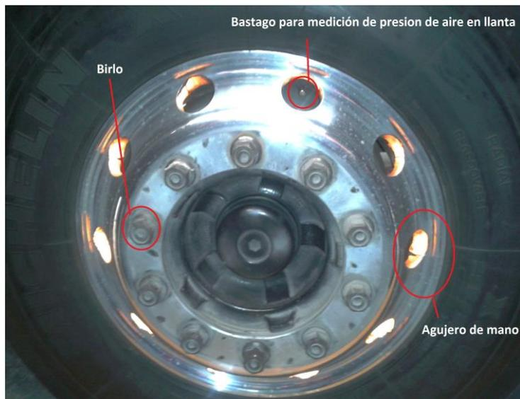
Figura 4.15. Fotografía de un Rin de aleación de un autobús.
