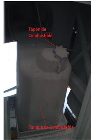
Figura 4.21. Fotografía de tanque de combustible con tapón.
