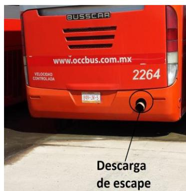
Figura 4.32. Fotografía descarga de escape óptima
