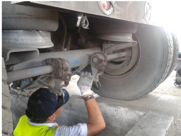
Figura 4.78. Fotografía inspección visual de Varilla de empuje en un remolque.
