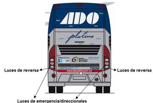
Figura 4.27. Esquema parte trasera de autobús Volvo 9700 6x2.
