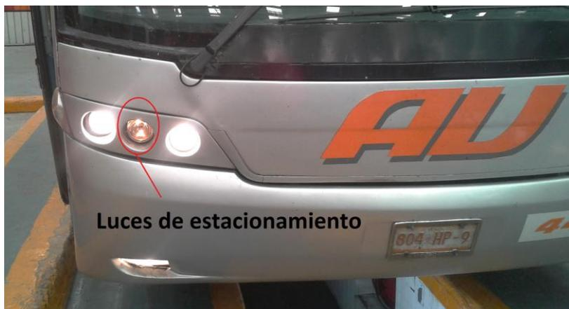
Figura 4.3. Fotografía Luces de estacionamiento de un autobús Scania Visstabus
