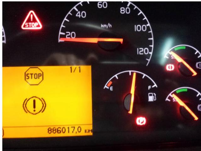
Figura 4.40. Fotografía de alarma visual en panel de instrumentos de baja presión de aire en frenos de un autobús Volvo 9700 6X2.
