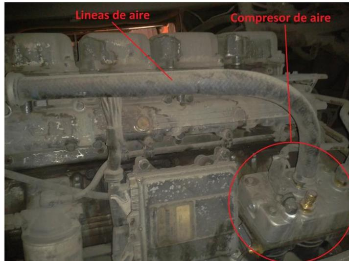
Figura 4.36. Fotografía de un compresor montado en el compartimiento del motor.
