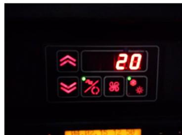
Figura 4.59. Fotografía caratula frontal del Sistema de Aire Acondicionado de un autobús Volvo 9700 6X2.
