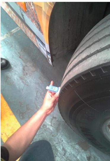
Figura 4.12. Fotografía de la medición de banda de rodamiento del neumático.
