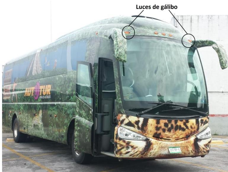
Figura 4.4. Fotografía Luces de Gálibo de un autobús Scania PB.
