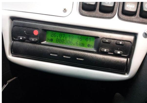
Figura 4.44. Fotografía de la caratula interactiva del Tacógrafo, ubicada en el tablero central del conductor.
