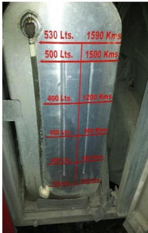
Figura 4.20. Fotografía de un tanque de combustible interior de un autobús Mercedes Benz OC500 FL.
