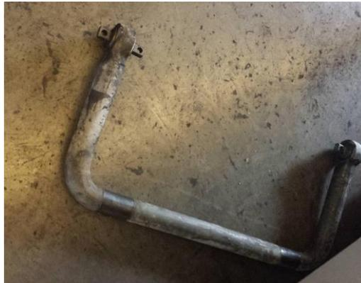
Figura 4.94. Fotografía de una Barra estabilizadora desmontada.
