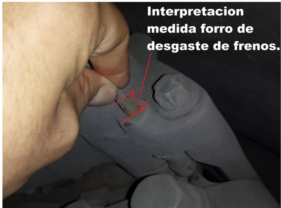
*Figura 4.83. Fotografía accionamiento de vástago para determinar parámetro de desgaste de forro de frenos de forma indirecta.*
