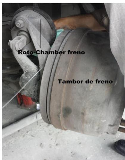
Figura 4.72. Fotografía de un Sistema de Frenos de Tambor.
