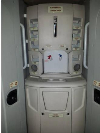
Figura 4.60. Fotografía de mueble de cafetería ubicado en la parte posterior del autobús.
