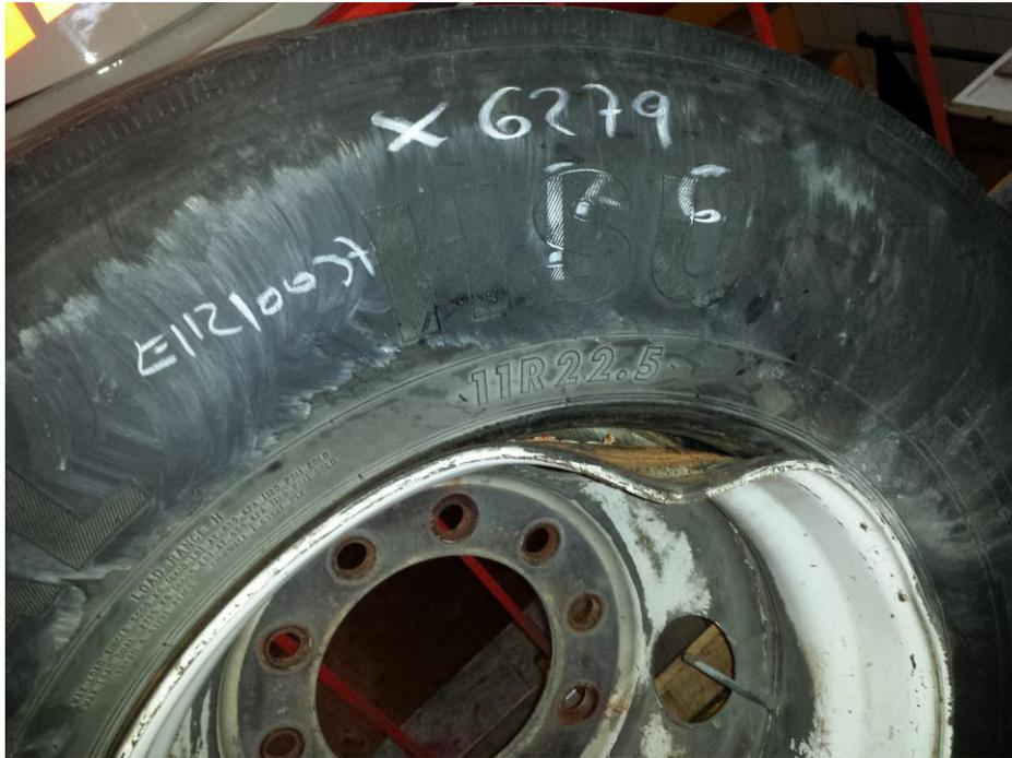
Figura 4.17. Fotografía de un rin quebrado ocasionado por un golpe.
