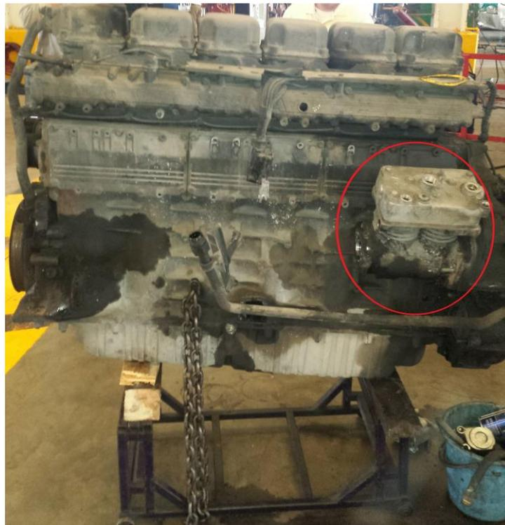
Figura 4.37. Fotografía de la ubicación de un compresor montado en un motor.
