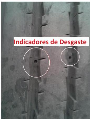
Figura 4.13. Fotografía de indicadores de desgaste en banda de rodamiento del neumático.
