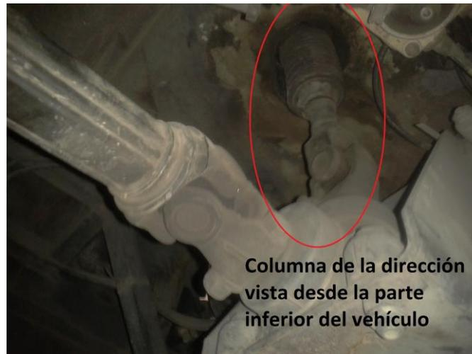
Figura 4.65. Fotografía columna de dirección parte inferior de un autobús.
