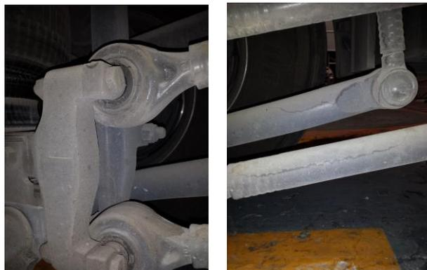
Figura 4.95. Fotografía de Barras de Reacción montadas en un autobús, vistas por la parte inferior del mismo.
