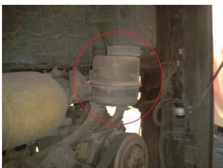
Figura 4.33. Fotografía depósito de aceite para Sistema de Dirección.
