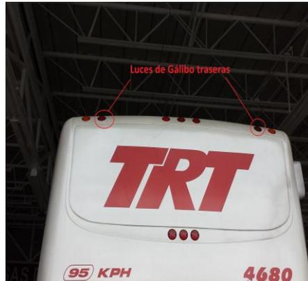
Figura 4.24. Fotografía Luces de Gálibo traseras de un autobús.
