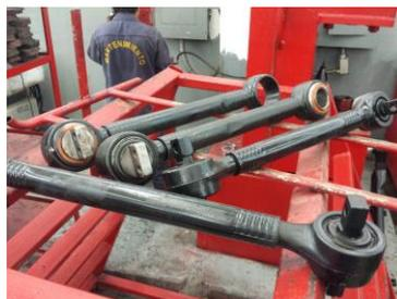
Figura 4.96. Fotografía de Barras de Reacción desmontadas.
