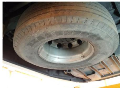
Figura 4.61. Fotografía de la rueda de refacción ubicada en la parte inferior del autobús.
