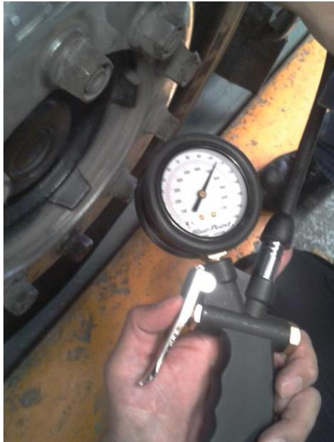
Figura 4.14. Fotografía de la Lectura de presión de inflado tomada con Manómetro de Bourdon.
