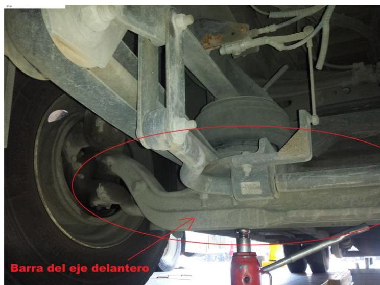
Figura 4.66. Fotografía Barra de eje.
