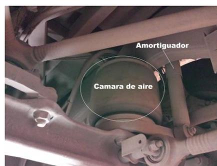
Figura 4.90. Fotografía de un autobús con Sistema de Suspensión Neumática.
