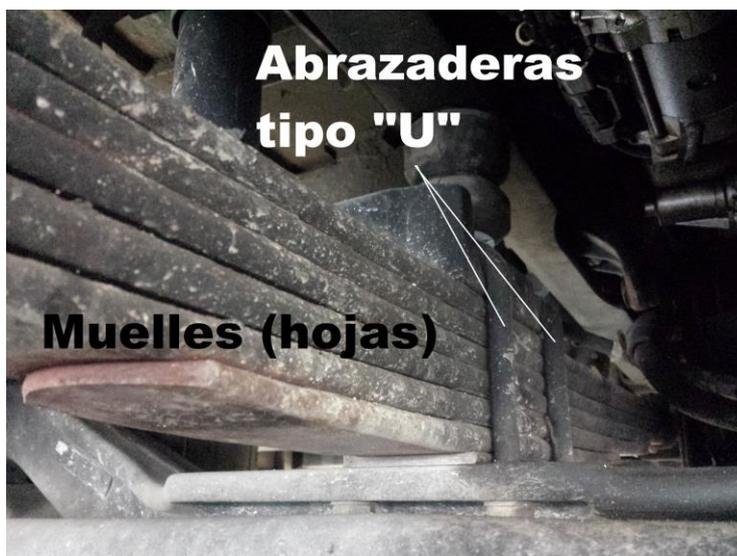
Figura 4.89. Fotografía de un autobús con Sistema de Suspensión Mecánica.
