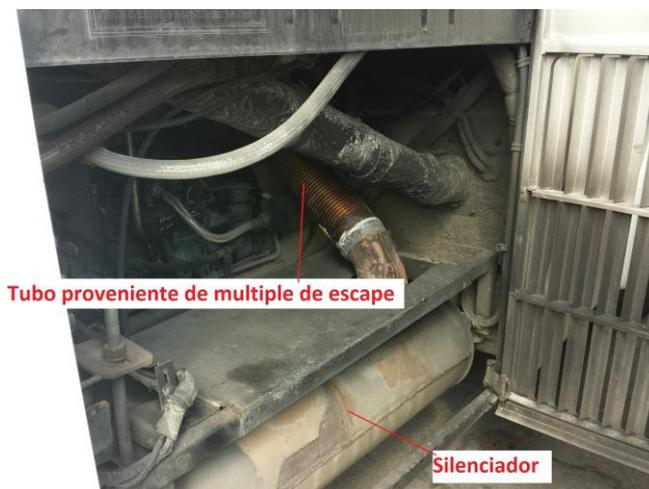
Figura 4.30. Fotografía vista lateral sistema de escape de un autobús.
