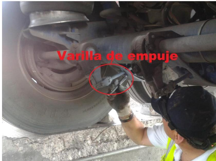
Figura 4.79. Fotografía de la medición de Varilla de empuje en un Sistema de Frenos de un remolque.
