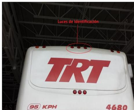
Figura 4.25. Fotografía Luces de Identificación traseras de un autobús
