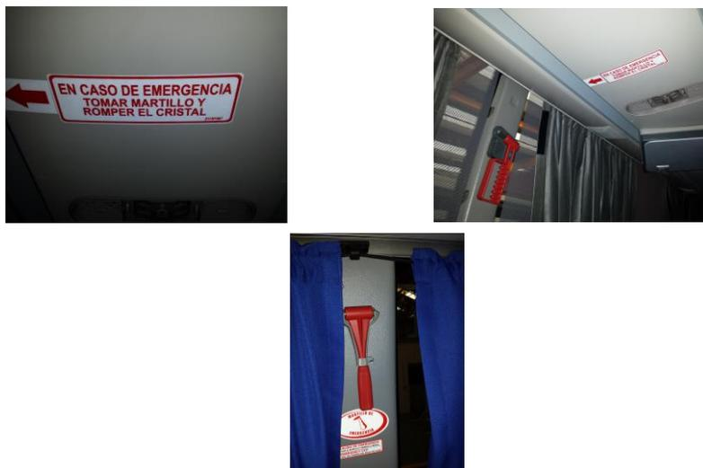
Figura 4.49. Fotografía de Martillos de seguridad con los señalamientos respectivos de ubicación para ser utilizados en caso de emergencia.
