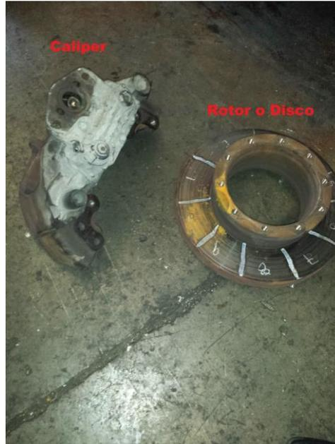
Figura 4.81. Fotografía de un Disco o Rotor de Sistema Frenos de Disco.
