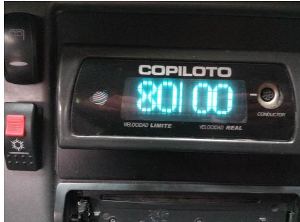
Figura 4.43. Fotografía de la caratula del controlador de velocidad ubicada en el tablero central del conductor.
