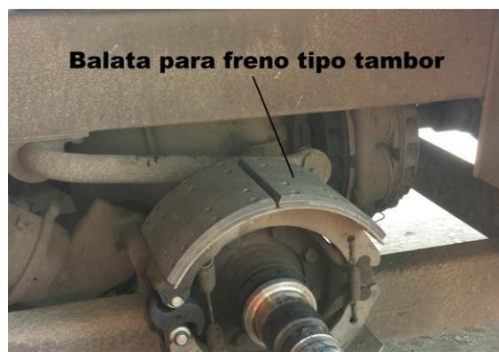
Figura 4.73. Fotografía de un Sistema de Frenos de Tambor desmontado.
