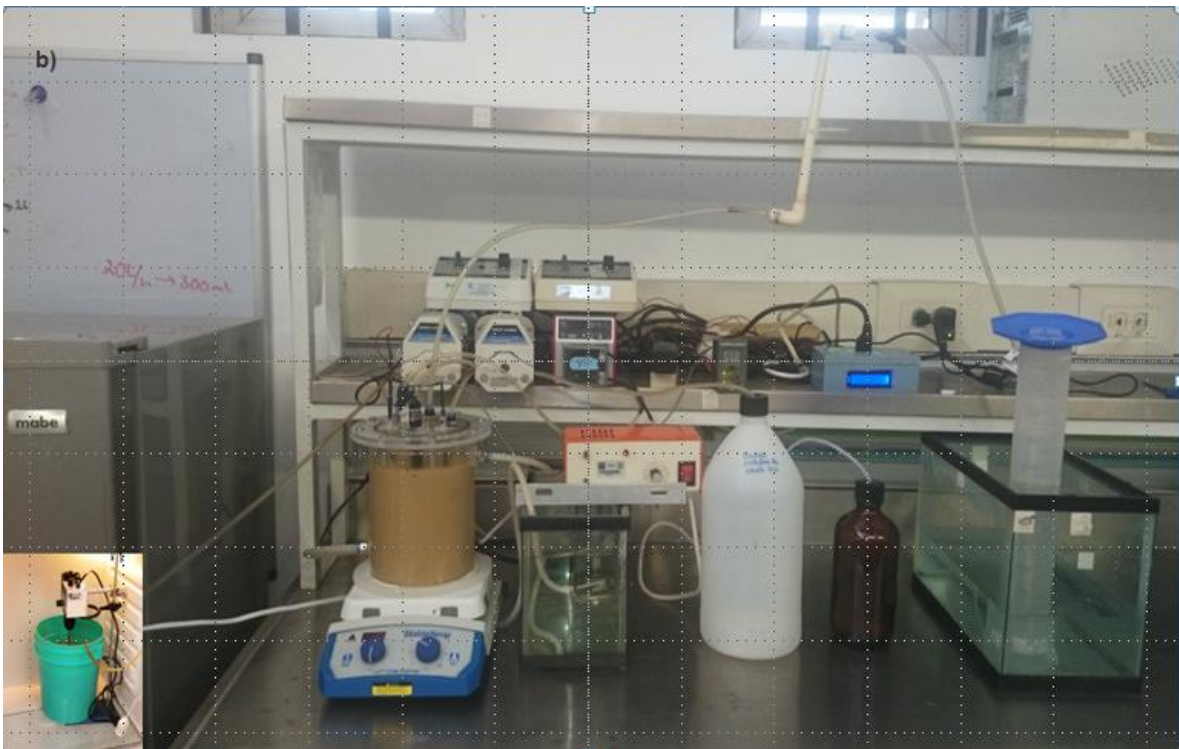
Figura 10. Diagrama de flujo de proceso de producción de hidrógeno (a) y fotografía del arreglo experimental (b)
