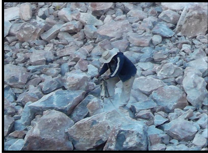
Figura 4.3 Uso de una perforadora neumática en la cantera “El Cerrito”.
