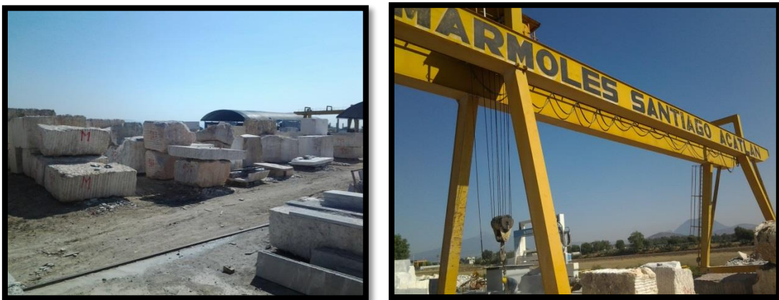
Figura 5.2 Grúa para mover bloques
