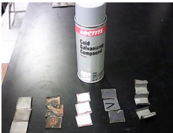
Figura 29. Ejemplo de producto y las muestras a cierto ángulo de inclinación y se recubren
