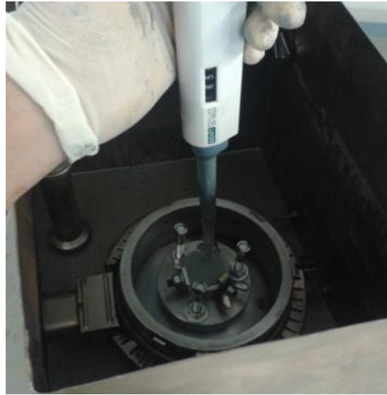
Figura 35. Deposición del sol gel por spin-coating
