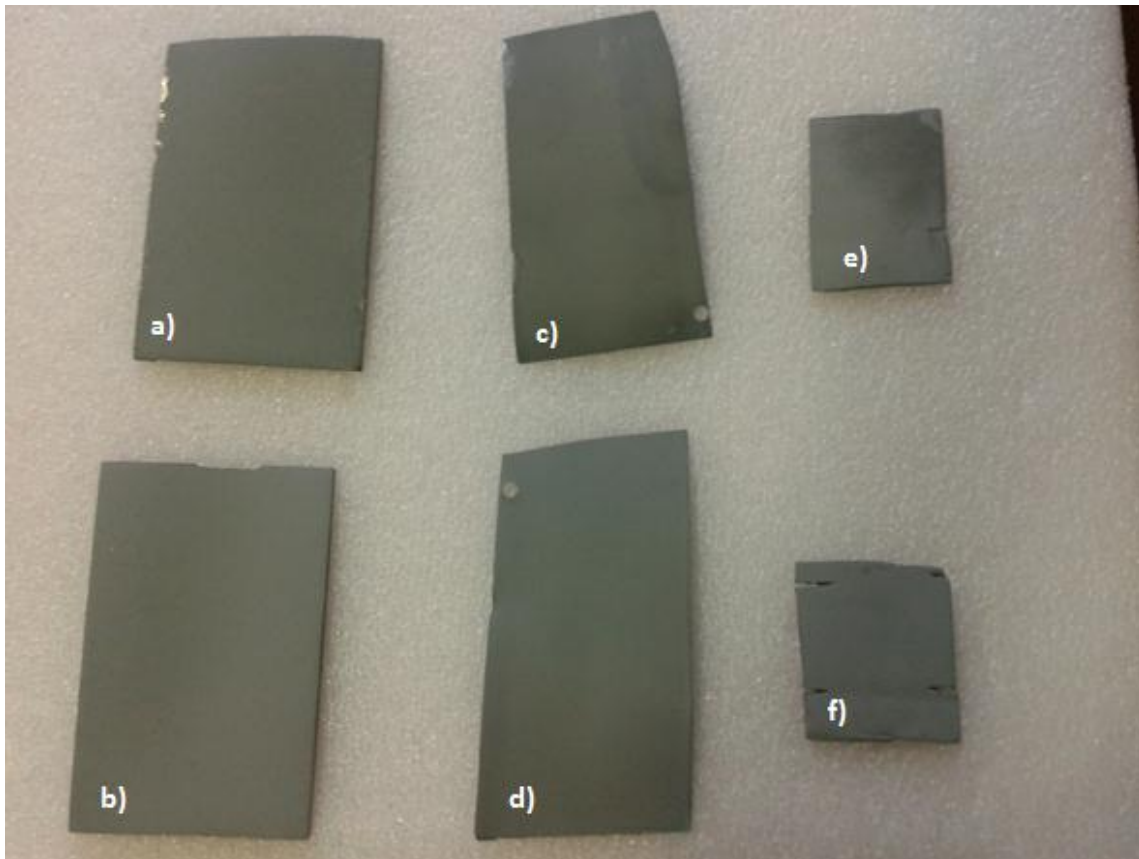
Figura 101. Muestras antes de someterlas al ensayo en la cámara de niebla salina.
