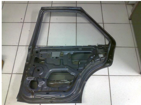
Figura 17. Parte interna de la puerta.
