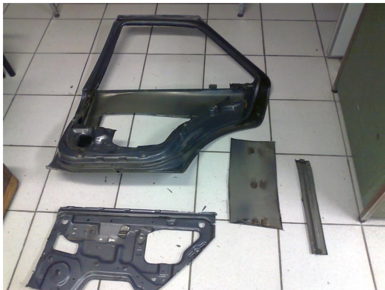
Figura 18. Puerta con sus cortes realizados (barra de contención, corte interno y corte externo).
