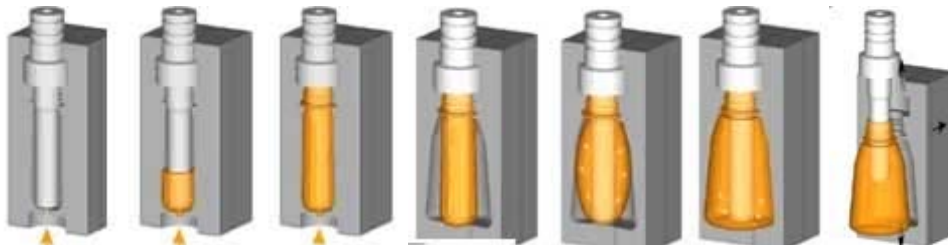
FIG. II.1. Proceso de soplado de una preforma
