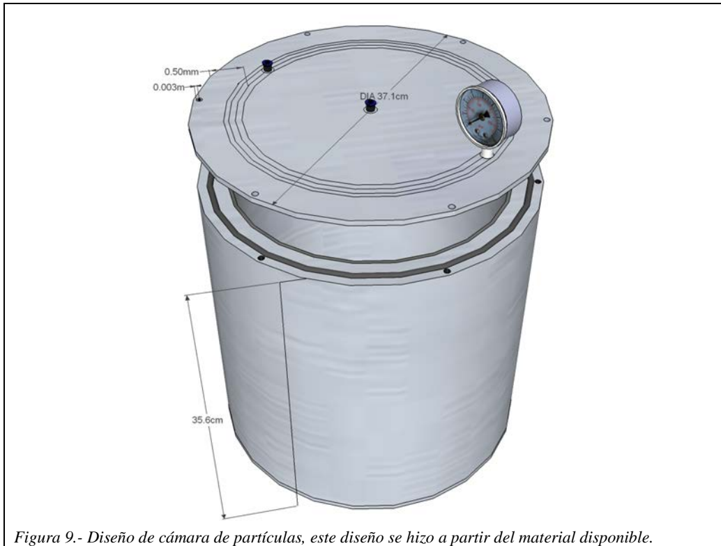
Figura 9.- Diseño de cámara de partículas, este diseño se hizo a partir del material disponible.
