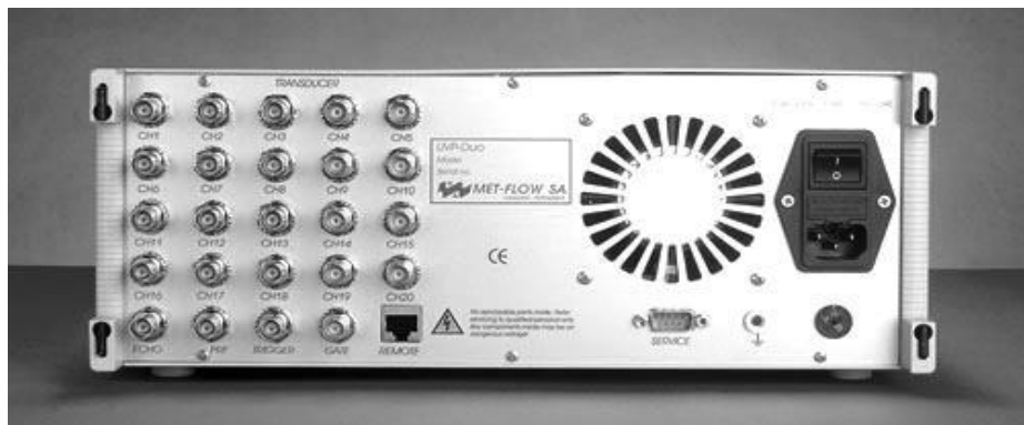
Figura 3. 7 Parte trasera de la unidad de control con 20 entradas de transductores.
