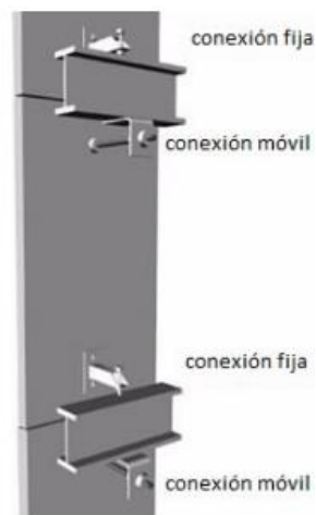
Figura 2.5 Sistema típico de FPC del tipo "piso a piso" (Modificado de WBDG, 2009).
