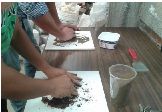
Figura 73. Moldeo de la porción de material de excavación
