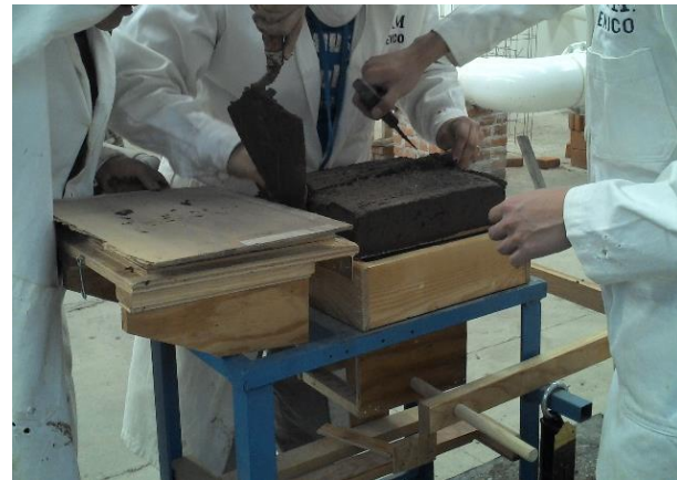
Figura 88. Extracción individual de ladrillos
