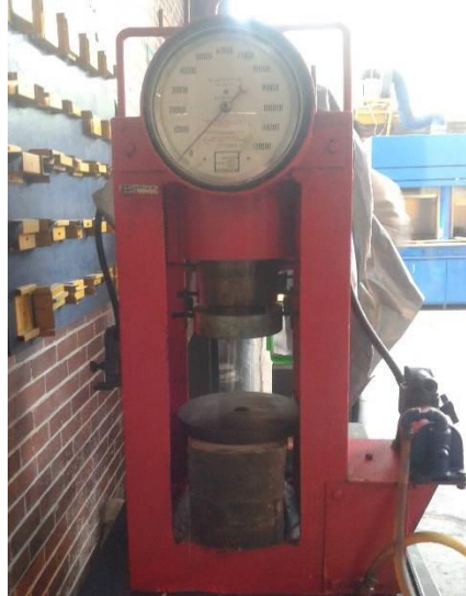
Figura 97. Equipo de compresión axial
