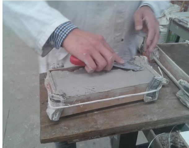
Figura 96. Aplicación de la mezcla yeso-cemento
