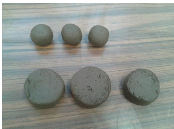
Figura 75. Bolitas y pastillas fabricados para un tipo de residuos de excavación
