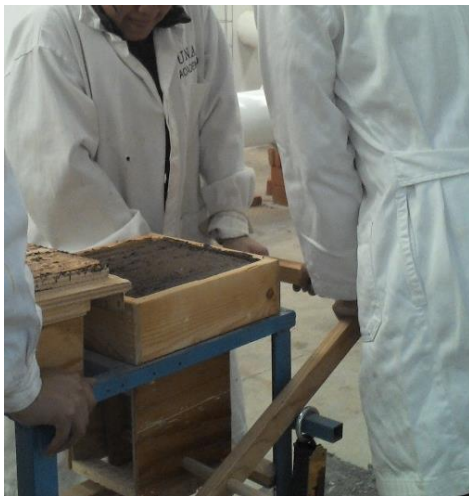
Figura 87. Aplicación de fuerza en la palanca para la extracción de ladrillos
