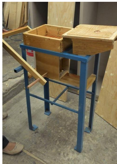
Figura 47. Máquina moldeadora de ladrillos
