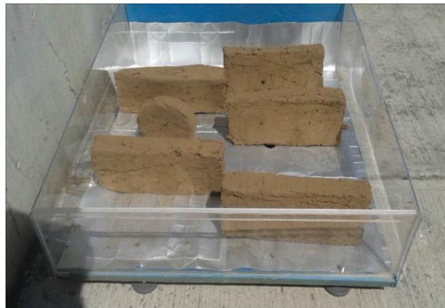
Figura 48. Secador solar de primera etapa
