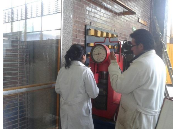
Figura 100. Toma de lectura del esfuerzo soportado por la pieza en prueba
