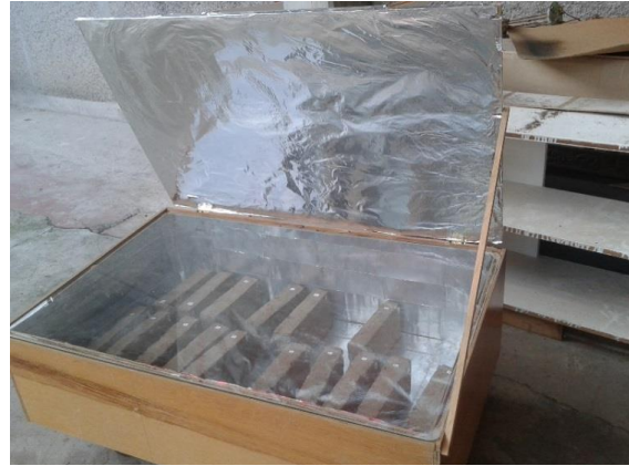
Figura 49. Secador solar mejorado
