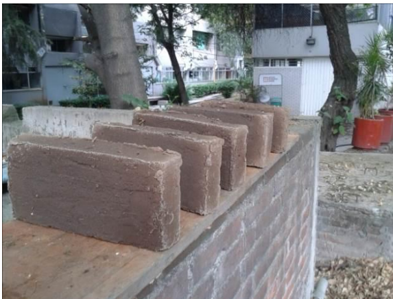
Figura 59. Secado de ladrillos al aire libre
