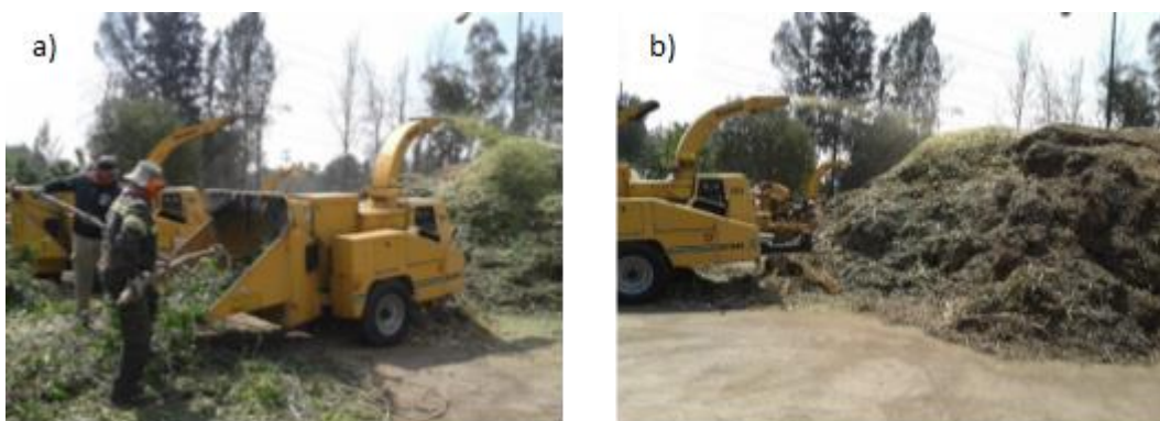
Figura 34. Trituración mecánica de residuos maderables
