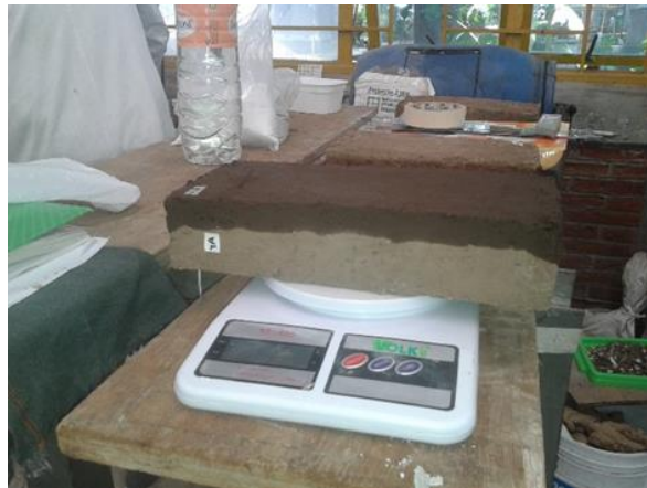
Figura 68. Determinación del peso posterior al periodo de sumersión
