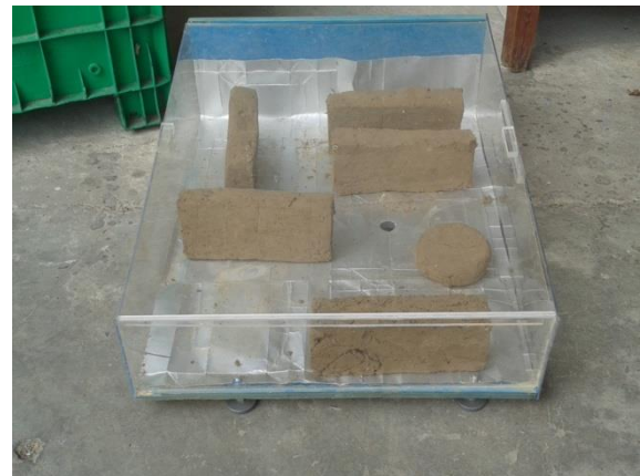
Figura 60. Secado de ladrillos dentro del secador solar
