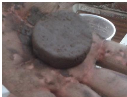
Figura 74. Pastillas moldeados con residuos de excavación
