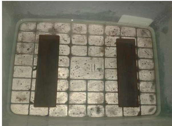
Figura 65. Ubicación de barras metálicas en el recipiente de prueba
