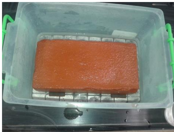
Figura 66. Ajuste de niveles de referencia con una ladrillo en estado saturado
