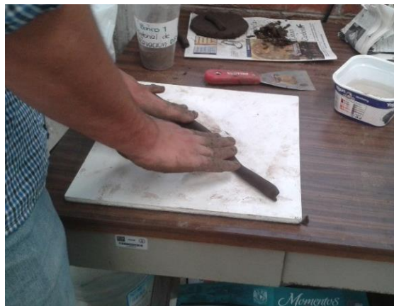
Figura 70. Elaboración de rollito con el material de excavación
