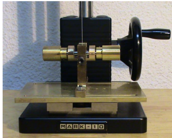
Figura 2.16. Instalación del espécimen en el banco de pruebas para un ensayo.
