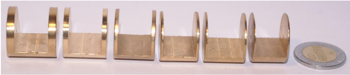
Figura 2.10. Cuarto grupo de bujes dobles de bronce. Distancia entre bujes constante de 12.7 mm. Diámetro interior de 1.200 mm y diámetro exterior de 19.30 mm.
