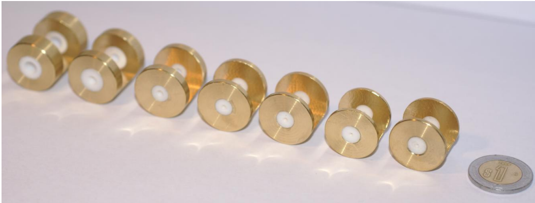
Figura 2.9. Tercer grupo de bujes dobles de teflón. Distancia entre bujes de teflón constante de 12.7 mm. De derecha a izquierda los bujes tienen un diámetro interior de 1.000, 1.200, 1.400, 1.587, 2.381, 3.175 y 4.762 mm.
