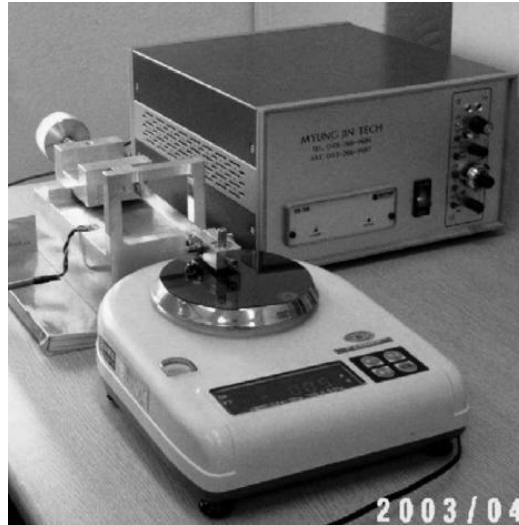
Figura 1.11. Tribómetro desarrollado por Rha et al. [25]. Tribómetro de viga en cantiléver oscilante.
