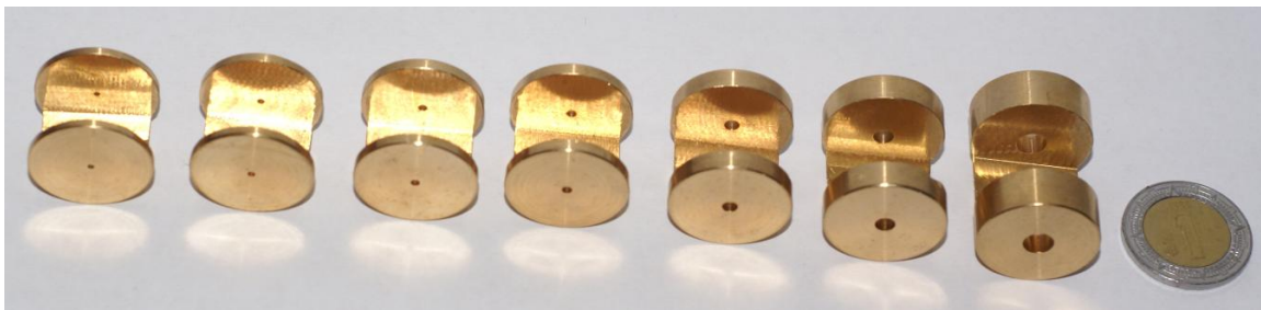
Figura 2.8. Segundo grupo de bujes dobles de bronce. Distancia entre bujes constante de 12.7 mm. De izquierda a derecha los bujes tienen un diámetro interior de 1.000, 1.200, 1.400, 1.587, 2.381, 3.175 y 4.762 mm.
