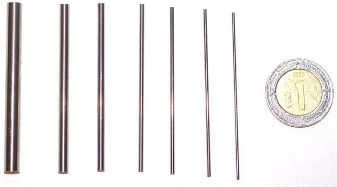
Figura 2.5. Juego de ejes del sistema experimental. Los ejes son pernos patrón de acero.
