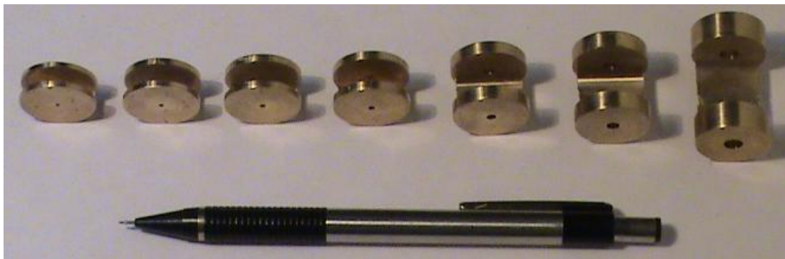
Figura 2.7. Primer grupo de bujes dobles de bronce. Distancia entre bujes variable. De izquierda a derecha los bujes tienen un diámetro interior de 1.000, 1.200, 1.400, 1.587, 2.381, 3.175 y 4.762 mm.
