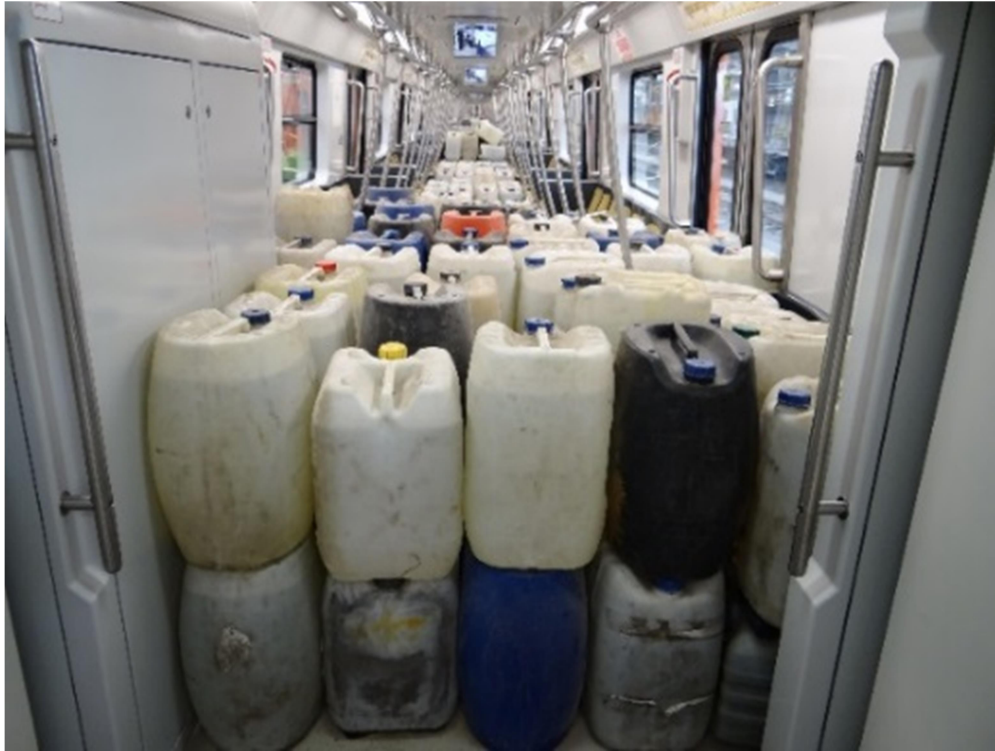
Fig 4.13 Tipo de lastrado en los trenes en las pruebas de campo de la Línea 12
