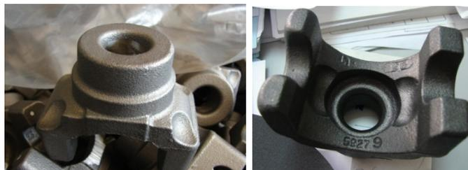
Foto 1. Pieza bruta en fundición
