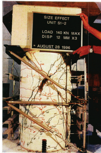
Figura 5.1.6: Formas de fallas encontradas en ensayos (a) [?] b) [? ]
