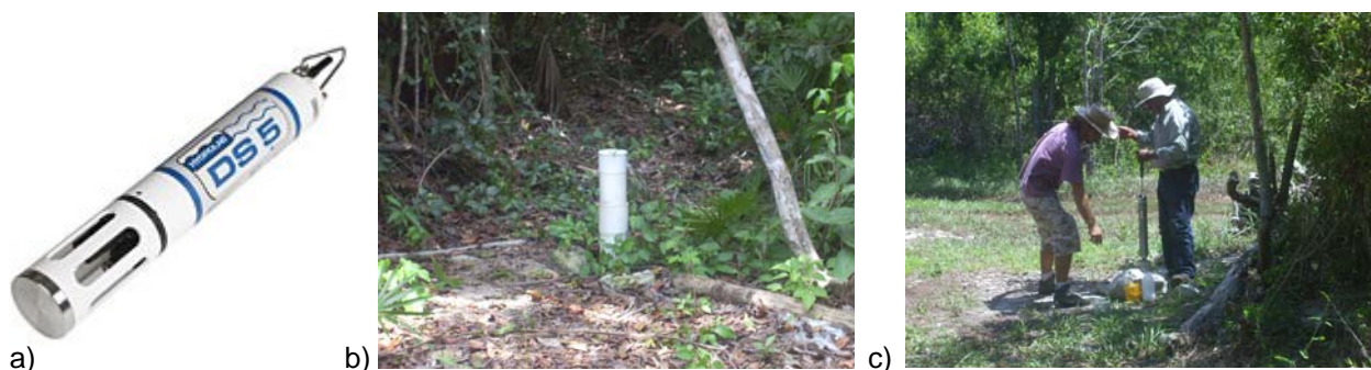
Figura 4.5 Muestreo de Pozos. a) sonda multiparamétrica HIDROLAB, b) muestra de piezómetros ubicados en el área de estudio, c) medición en piezómetros
