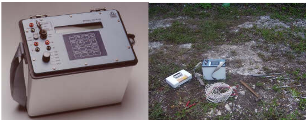
Figura 4.2 Equipo para prospección eléctrica SYSCAL R1.
