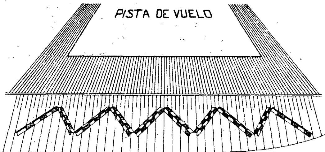
Figura 2-1.- Señales en las pendientes situadas inmediatamente antes del extremo de la pista
