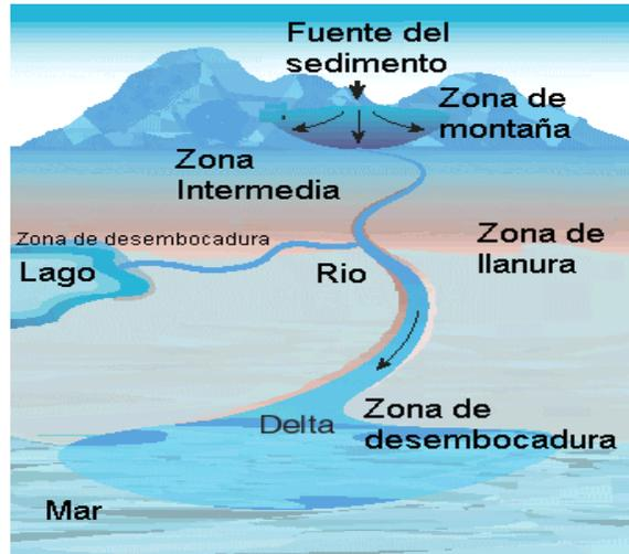
Figura 4. 2 Esquema de un sistema fluvial (oildfiel glossary, 2007).
