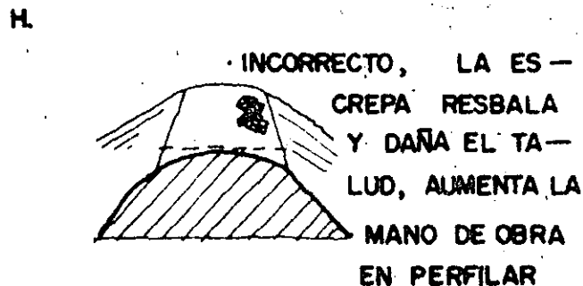
FORMACION DE TERRAPLENES
