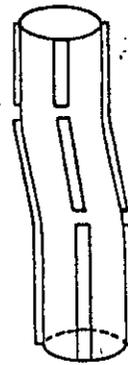
b.- Dispositivo para medir desplazamientos laterales.
