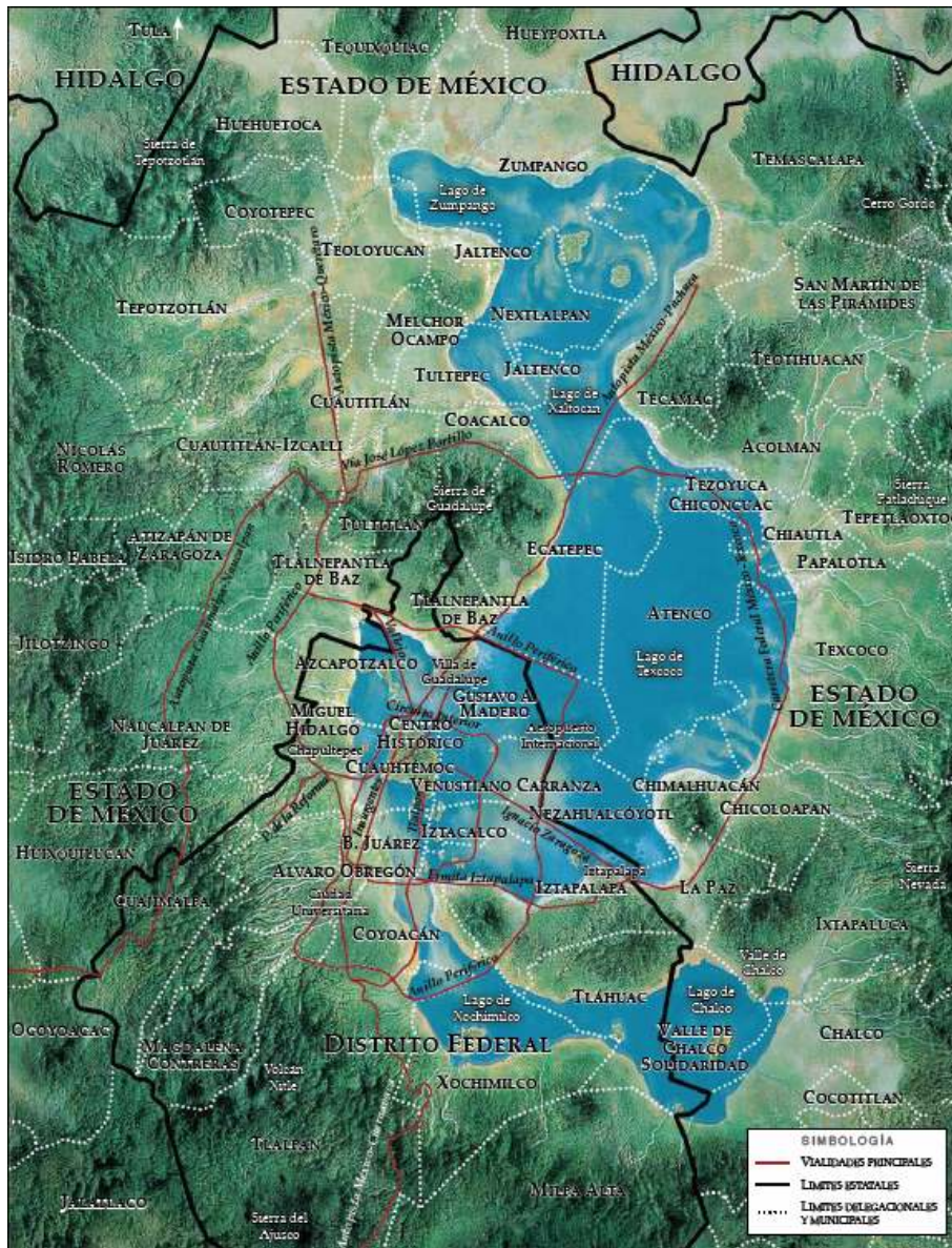
Figura 4.5. Lagos antiguos de la cuenca de México. Los efectos dañinos que ocasionan los sismos provenientes de la costa del Pacífico a la Ciudad de México, se deben en parte, a que la ciudad se erigió encima de sedimentos, legado de los lagos que se muestran en la figura (tomado de Arqueología Mexicana; Vela, 2007).
