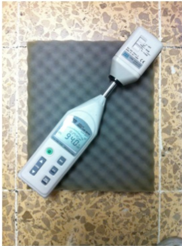
Figura 2.38 Calibración del sonómetro a 94 dB – 1kHz
