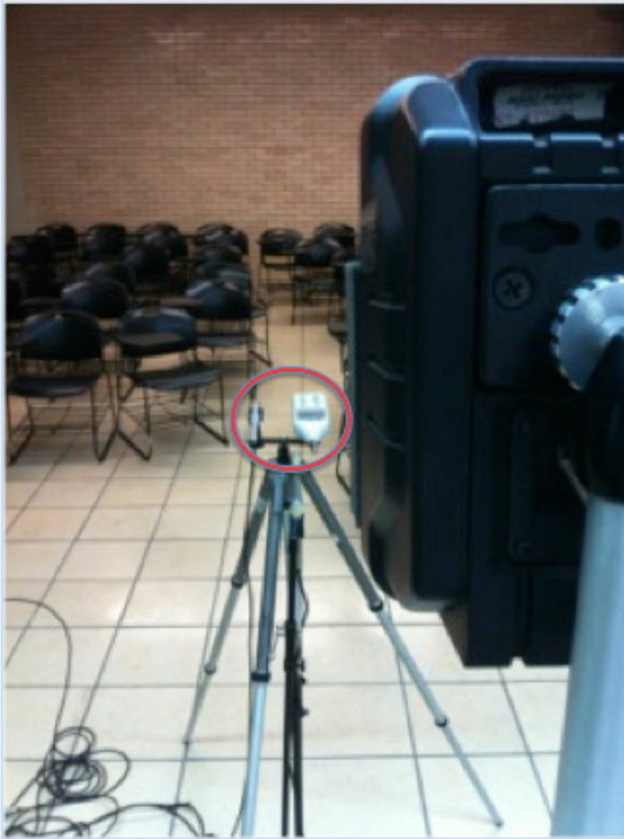
Figura 2.29 Posición 1 del micrófono omnidireccional, como se aprecia en la imagen, esta es la misma posición en la que se realiza el aplanamiento de la señal MLS por octavas de banda para obtener los parámetros acústicos del recinto
