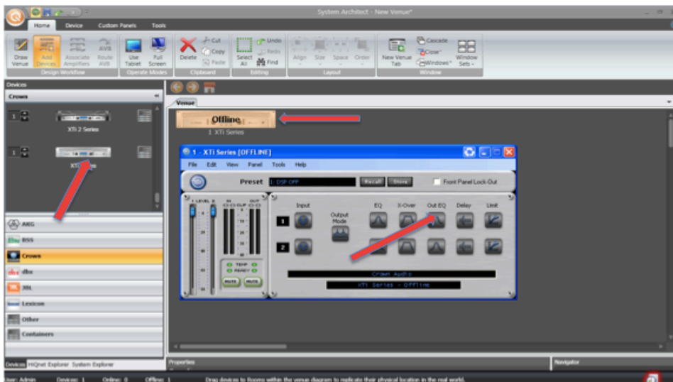
Figura 2.25 Primeros ajustes para la ecualización de la señal MLS en System Architect 3.4
