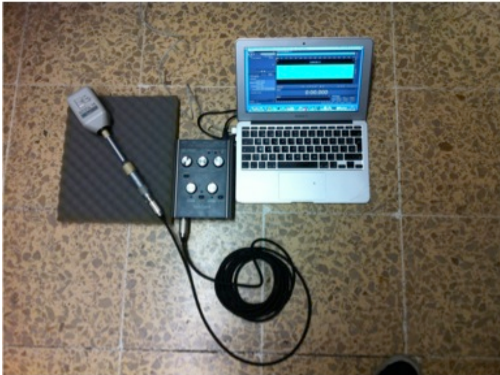
Figura 2.37 Grabación del tono de calibración a 94dB – 1kHz en Adobe Audition
