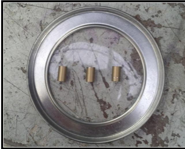
Figura 10 Probetas de Aleación de Titanio de 0.010 metros de longitud
