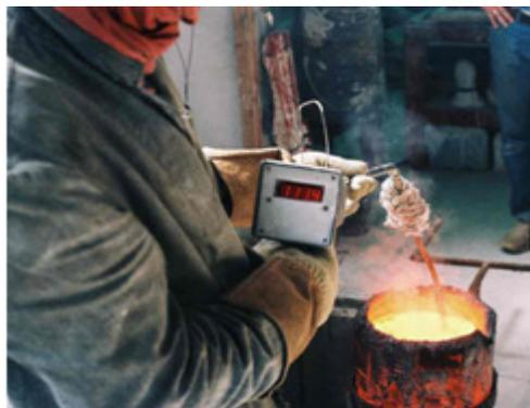
*Figura 5.4. Medición de temperatura de fusión de un metal*
