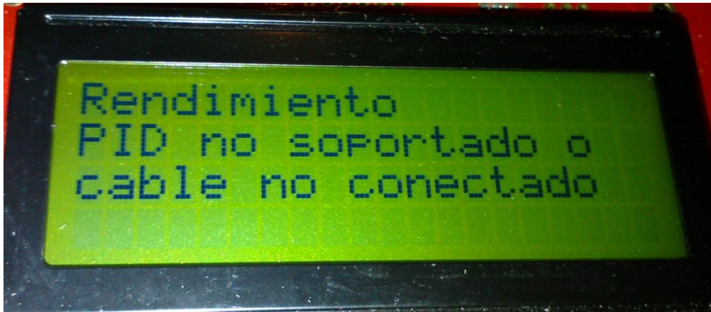
Figura 4.18. Prueba a la función que muestra parámetros del automóvil.
