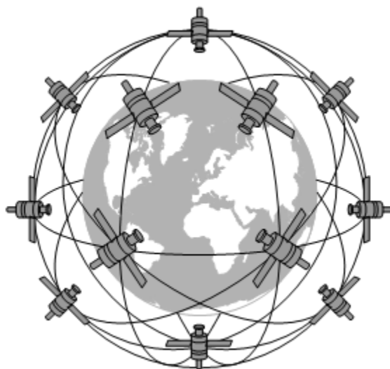
Figura 2.41. Constelación de satélites NAVSTAR y sus órbitas.
