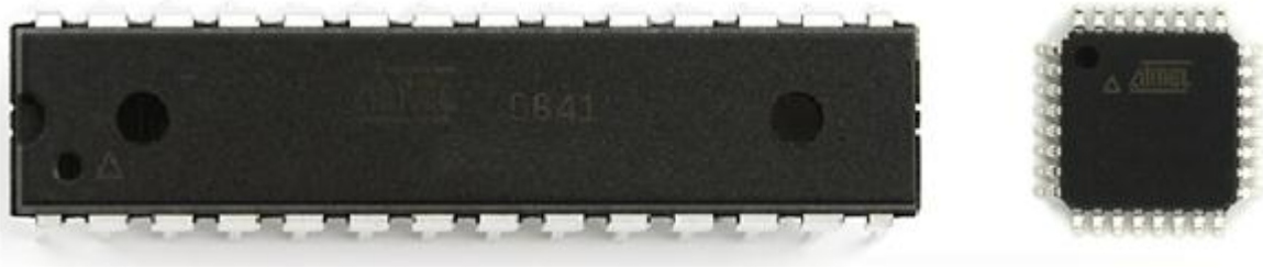
Figura 3.2. AVR, empaquetado DIP (izquierda) y TQFP (derecha).
