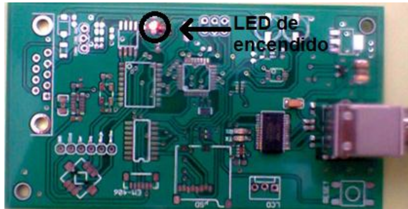
Figura 4.11. Componentes de la conexión USB.
