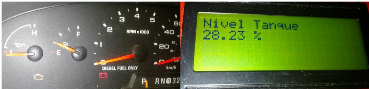
Figura 4.44. Nivel de combustible visto en tablero y en el UNAM-CAN.
