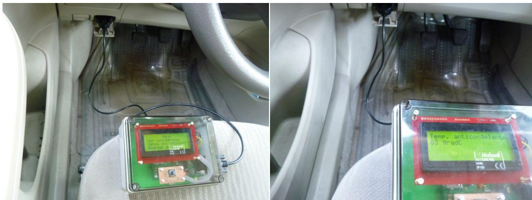
Figura 4.55. UNAM-CAN conectado a un vehículo.
