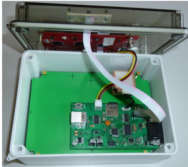
Figura 4.52. Montaje de la tarjeta en el gabinete.
