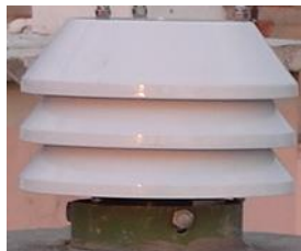
Sensor de temperatura mínima a la interperie (a 10 cm de la superficie)
