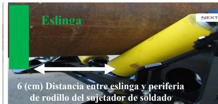
Fig. 3.6 Distancia entre eslinga y periferia del rodillo
