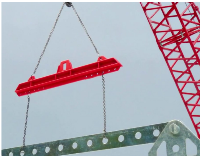
Fig. 1.2 Viga de carga # YCC 702-1
