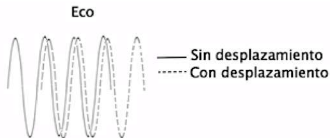
Figura 12: Esquema que representa el eco de una partícula sin desplazamiento (línea continua) y el de una partícula con desplazamiento (línea punteada).
