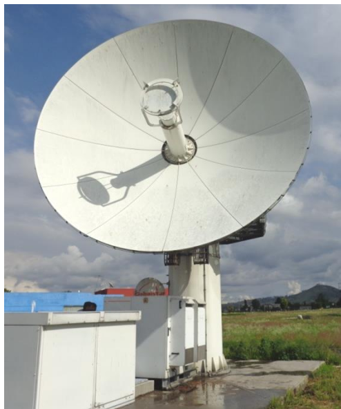
Figura 1-6 Antena de Seguimiento, Telemetría y Comando (GlobalStar)
