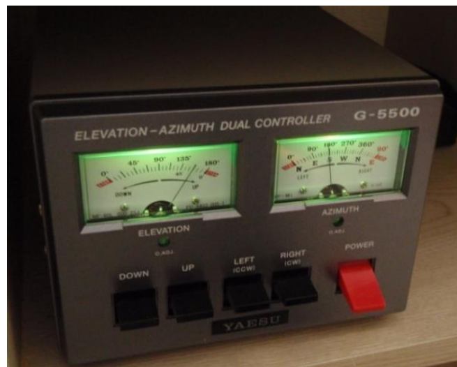
Figura 5-19 Control del rotor en azimut y elevación 24
