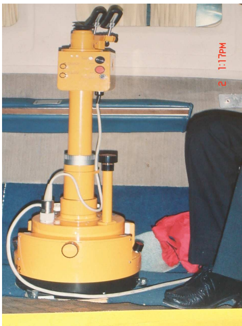
Mira de navegación colocada en el piso del avión
