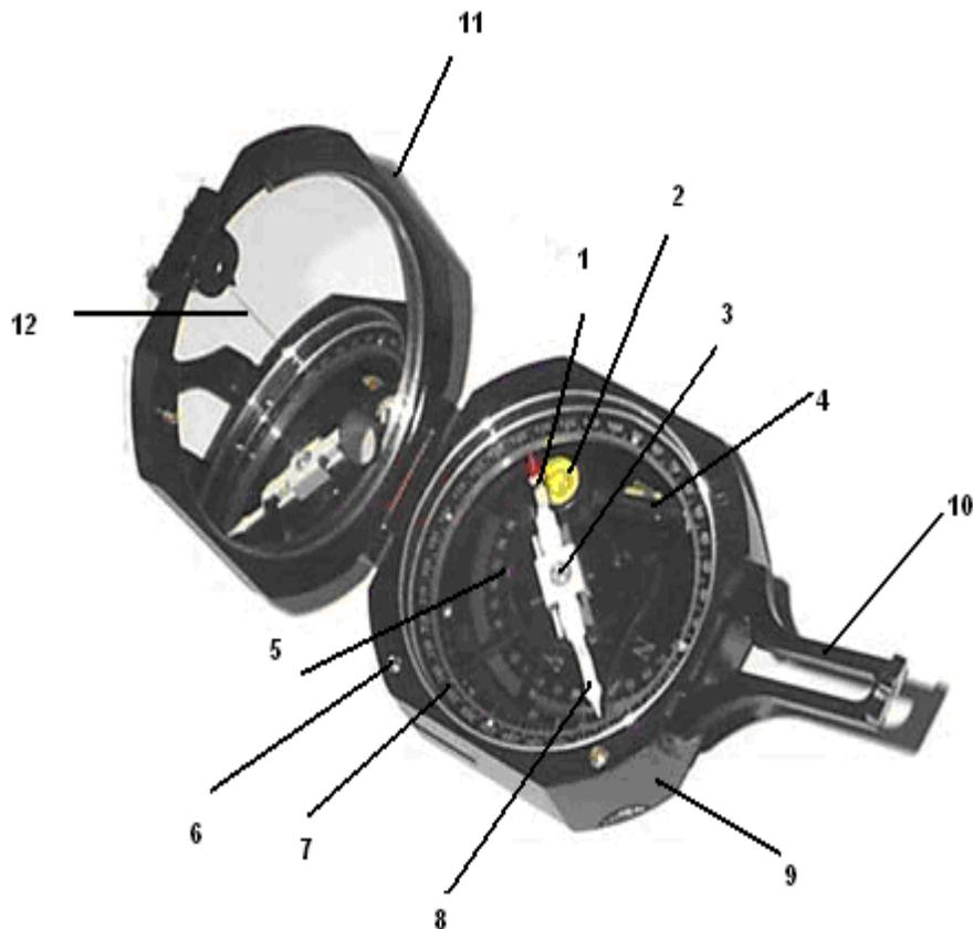
1. Contrapeso en la parte de la aguja magnética que apunta al sur a fin de que la aguja permanezca horizontal una vez nivelada la caja de la brújula mediante el nivel circular.
